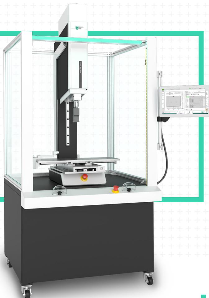
L'unione del sistema servo ad alta precisione delle saldatrici MS sonxTOP, con una tavola X-Y elettrica multi-posizione, automatizza e rende flessibile il processo produttivo.
